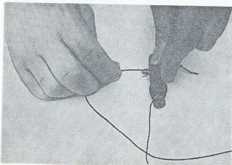
Sl. 69b. Odvajanje električnih priključaka sa upaljača
